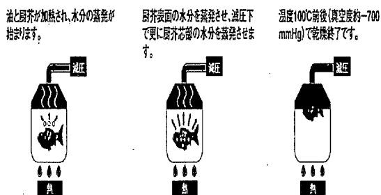
図1：油温減圧乾燥システムの原理
