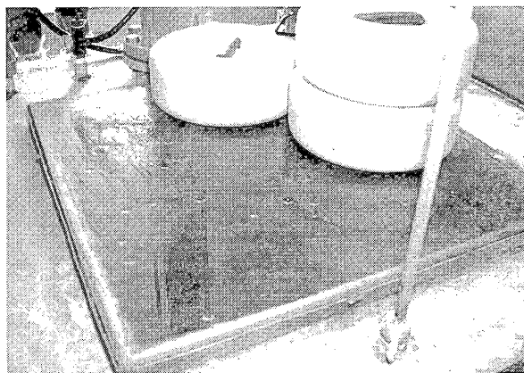
写真20 第1次発酵槽上部のガラス窓
