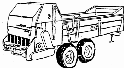
図3 後方排出方式で散布幅を広げたマニュアルスプレッダ（TS-600L型）
